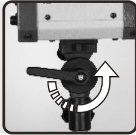
Para o ajuste de posicionamento do Flash, solte a manópla e efetue a rotação fixando a novamente. Segure o Digiflash firmemente antes de soltar a alavanca.
