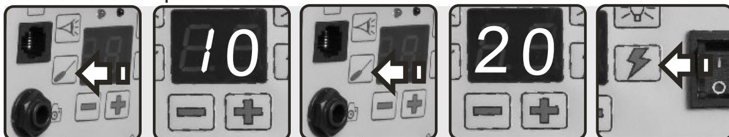
Aperte o botão função três vezes seguida para entrar no modo de programação (fig.1). O primeiro Dígito (fig 2) (indicado pelo número 1) determina a função. Pressionando as teclas (+) e (-) (fig.3) habilita-se (1) ou desabilita-se (0) a função mostrada no display no segundo dígito (fig2 e 3). Para sair do modo programação tecle Disparo Teste (fig4).
