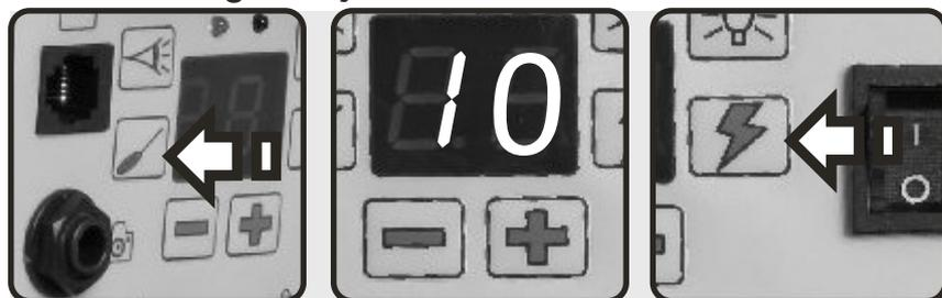
Aperte o botão função três vezes seguida para entrar no modo de programação (fig.1). O primeiro Dígito (fig 2) (indicando o número 1) determina a função. Para avançar as funções aperte repetidamente a tecla função (fig1) até a função desejada, pressionando as teclas (+) e (-) (fig.2) habilita-se (1) ou desabilita-se a função mostrada no display no segundo dígito (fig2). Para sair do modo programação tecle Disparo Teste (fig3).
