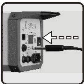
Conecte o cabo de sincronismo no equipamento utilizando a ponteira P10.
