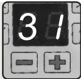
Aperte o botão função uma única vez (fig.1) pressionando as teclas (+) e (-) (fig.2) para efetuar o ajuste de sensibilidade.
