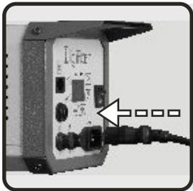
Conecte o cabo de energia ao aparelho, observando o devido aterramento da rede.
